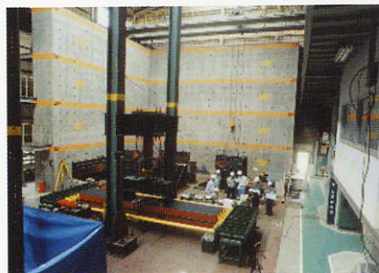
継手曲げ試験状況
