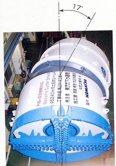
中折れ状況 / Mid-bend
